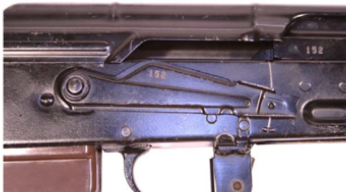
Pozycja 8: dźwignia bezpiecznika w pozycji ciągły/automatyczny.
