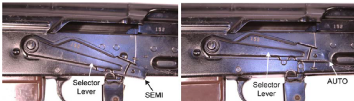
Pozycja 3: dźwignia bezpiecznika w pozycji Pojedynczy (po lewej) i Ciąły/Automatyczny (po prawej)
