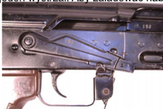
Pozycja 7: dźwignia bezpiecznika w pozycji pojedynczy.
